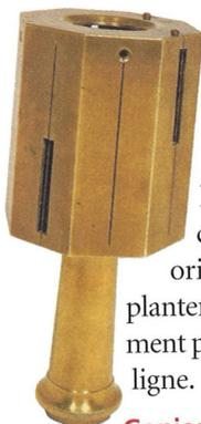
**Goniomètre** : instrument servant aux mesures des angles horizontaux contrairement à l'éclimètre (cf. image ci-contre).
