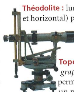
**Théodolite** : lunette montée sur deux axes (vertical et horizontal) pour réaliser les angles d'un triangle. Chacun des axes est équipé d'un cercle gradué permettant les lectures des angles.
